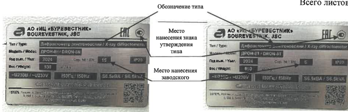
Рисунок 3 – Вид планки фирменной (шильдика) с обозначением типа и заводским номером дифрактометров рентгеновских моделей ДРОН-8Н и ДРОН-8Т
