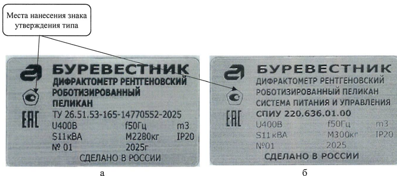
Рисунок 2 – Вид фирменных табличек (а – табличка, устанавливаемая на защитный кабинет, б – табличка, устанавливаемая на систему питания и управления)
